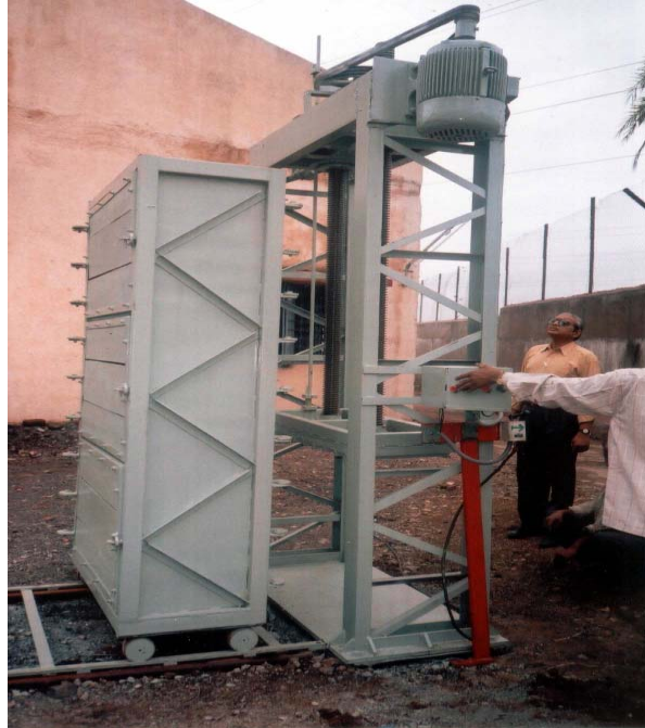
Figure 3 Mechanical press for a mini cotton gin
